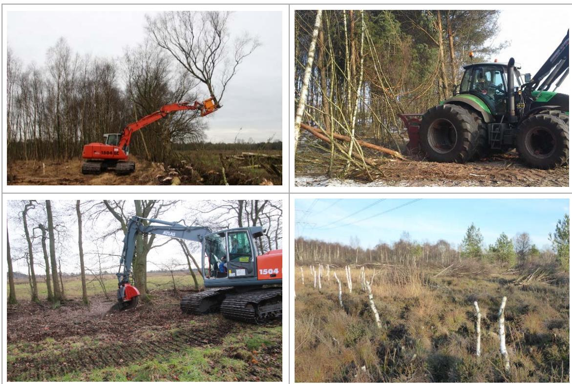
Abb. 4.1: Oben links: Moorbagger mit hydraulischer Baumschere (Lichtenmoor, LK Nienburg/Weser, 2020; Foto: T. Beuster).
