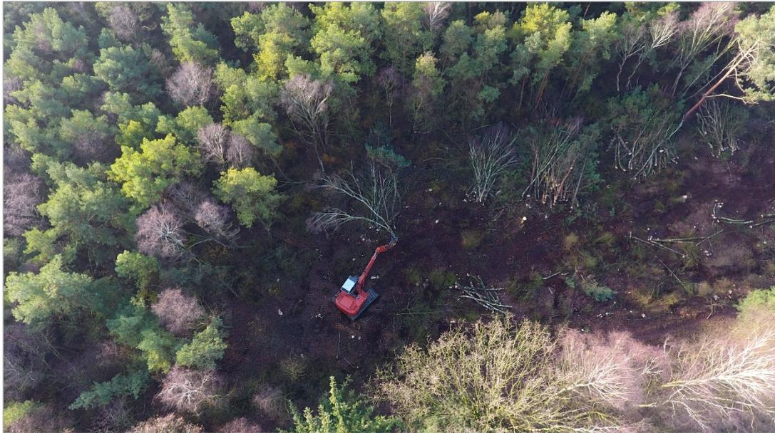
Abb. 8.3: Moorbagger mit hydraulischer Baumschere (Lichtenmoor, LK Nienburg/Weser, 2019; Foto: T. Beuster).
